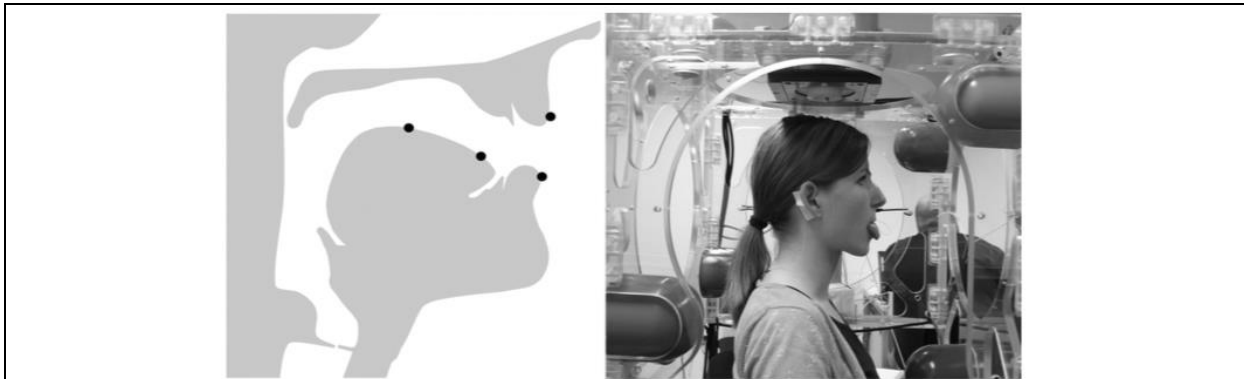
Abbildung 1: Platzierung der Spulen im Oraltrakt (links) sowie eine Probandin (rechts) bei der Aufnahme artikulatorischer Daten (Hermes & Mücke 2016: 33)
